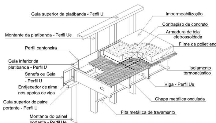
Figura 5.1 - Cobertura plana em Light Steel Framing
