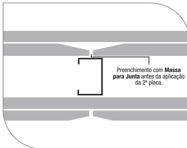
As **Placas Cimentícias** devem ser aplicadas encostadas no teto para facilitar o tratamento posterior da junta e devem ter folga de 10 mm em relação ao piso para evitar a absorção de umidade por capilaridade.
