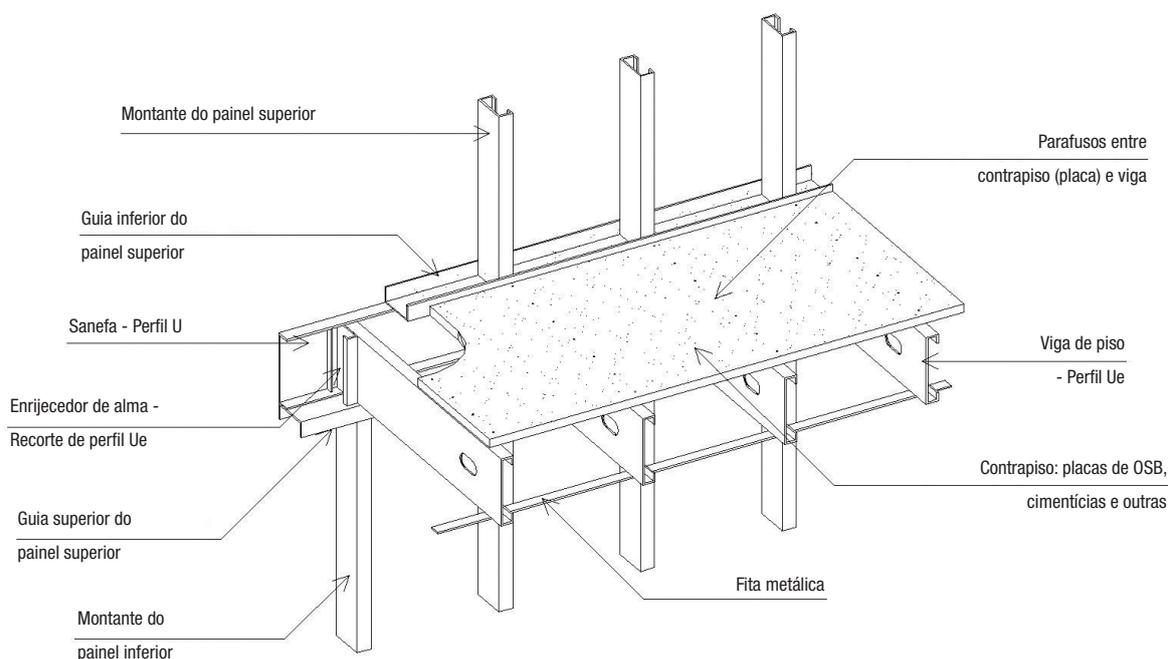
Figura 4.6 - Desenho esquemático de laje seca com painel **Masterboard**
