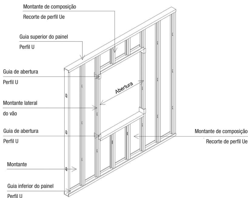
Figura 3.26 - Desenho esquemático de painel não estrutural com abertura
