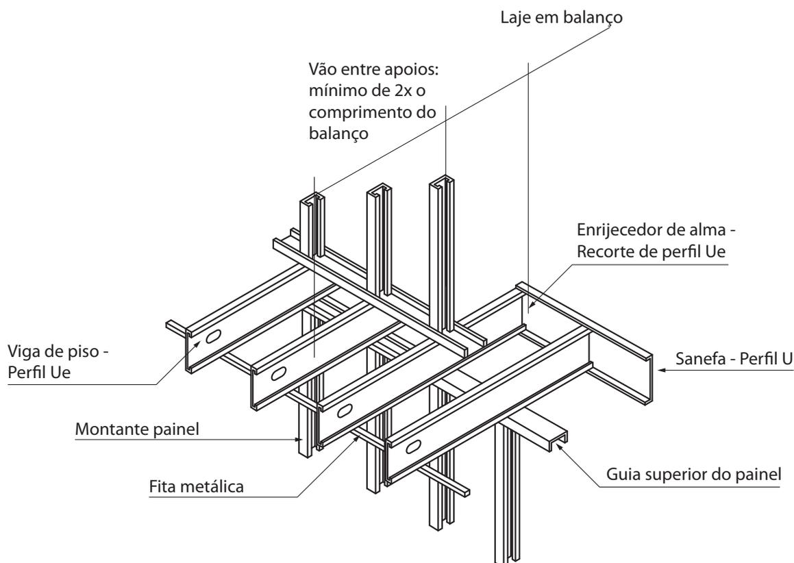
Figura 4.9 - Laje em balanço
