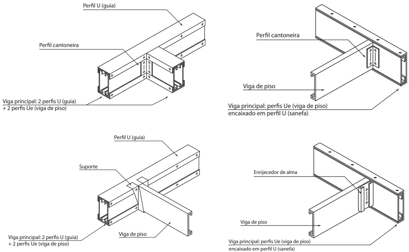
Figura 4.14 - Tipos de vigas principais para apoio de vigas de piso
