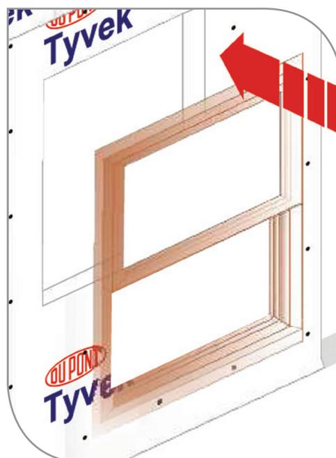
B) Sele ao redor das janelas, tanto na parte interior quanto exterior da estrutura utilizando **Selamax**.
