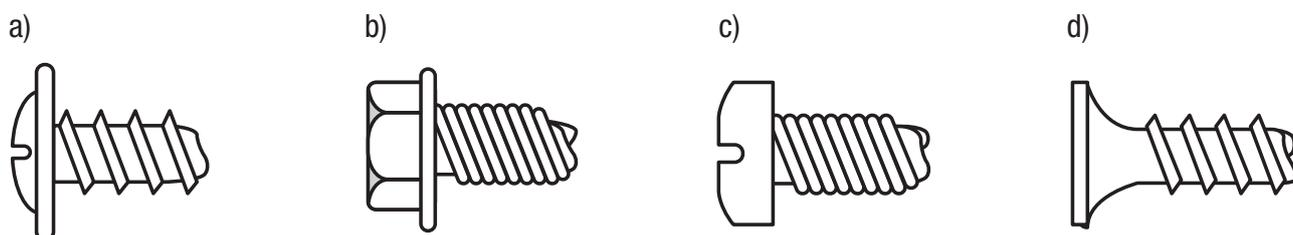
Figura 7.3 - Tipos de cabeça de parafusos mais utilizados em ligações com LSF:
