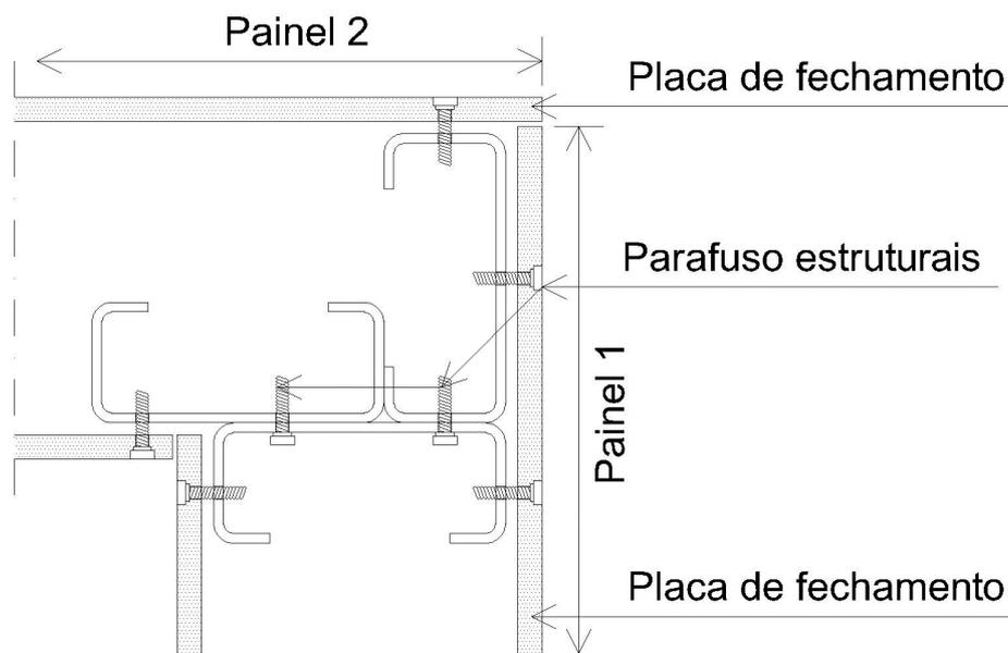
Figura 3.21 - União de três montantes
