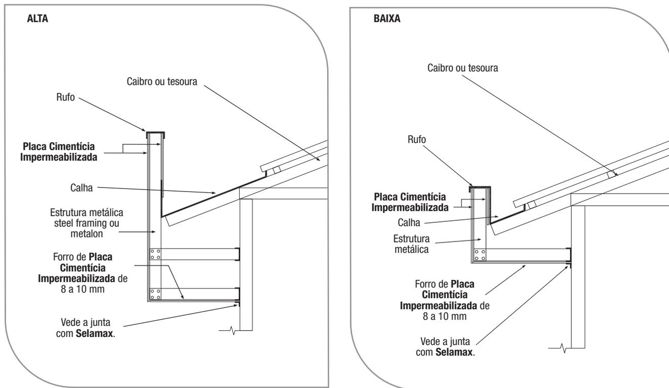
Também é possível incorporar uma platibanda de **Placa Cimentícia** a uma edificação já existente, conforme imagens a seguir.
