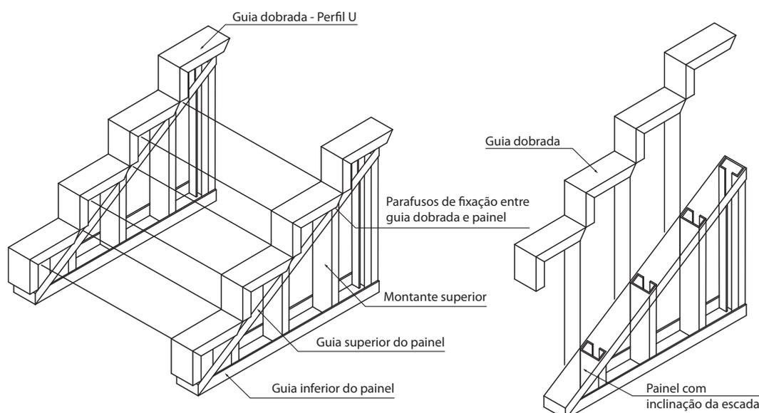
Figura 4.19 - Desenho esquemático de escada painel com inclinação
