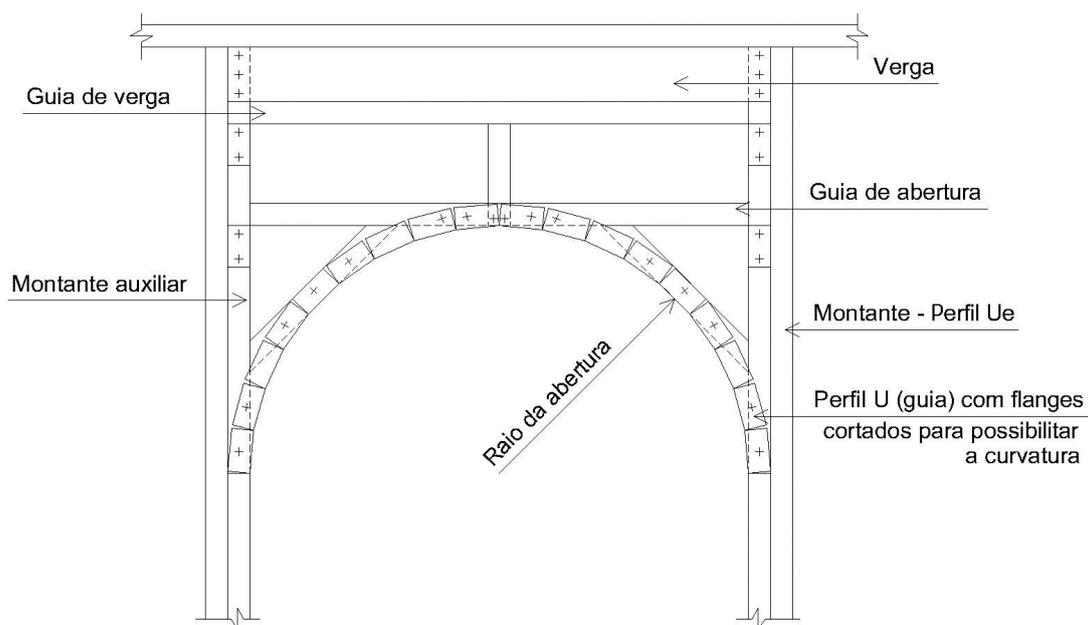
Figura 3.28 - Método para construção de aberturas em arco
