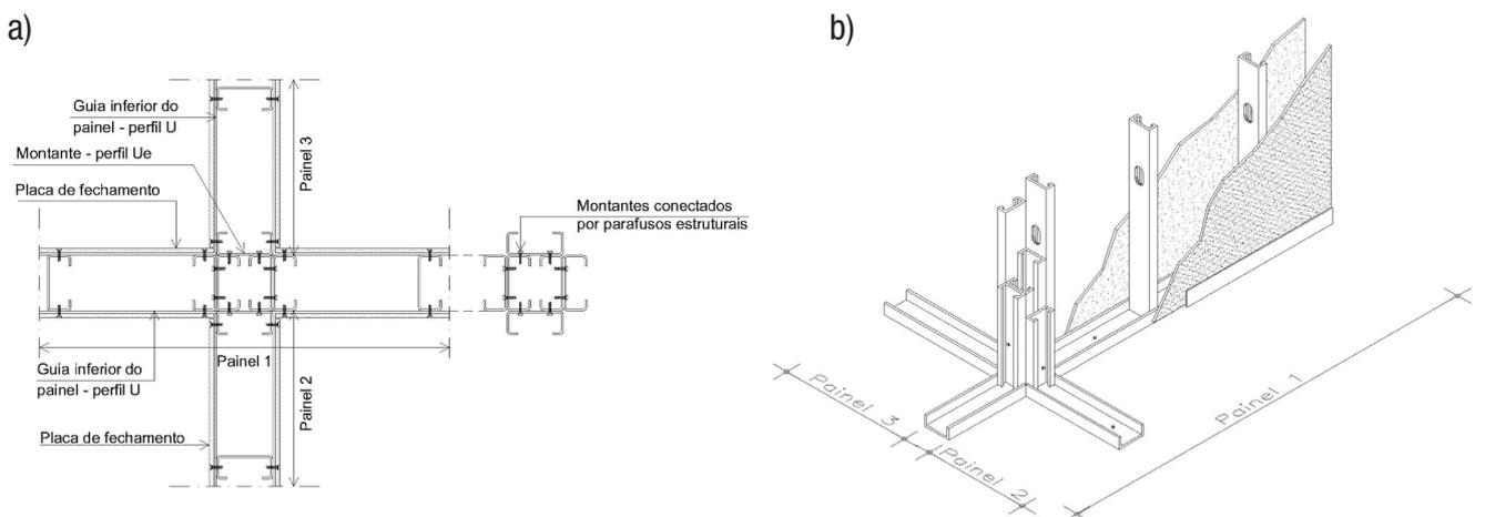
Figura 3.24 - Encontro de três painéis: a) planta b) perspectiva
