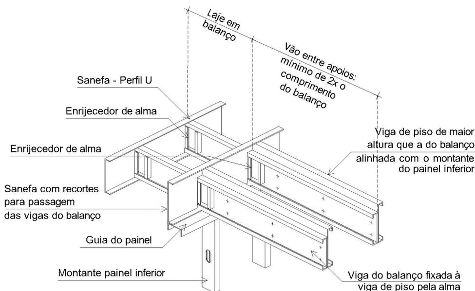
Figura 4.11 - Laje em balanço com contrapiso em níveis diferentes
