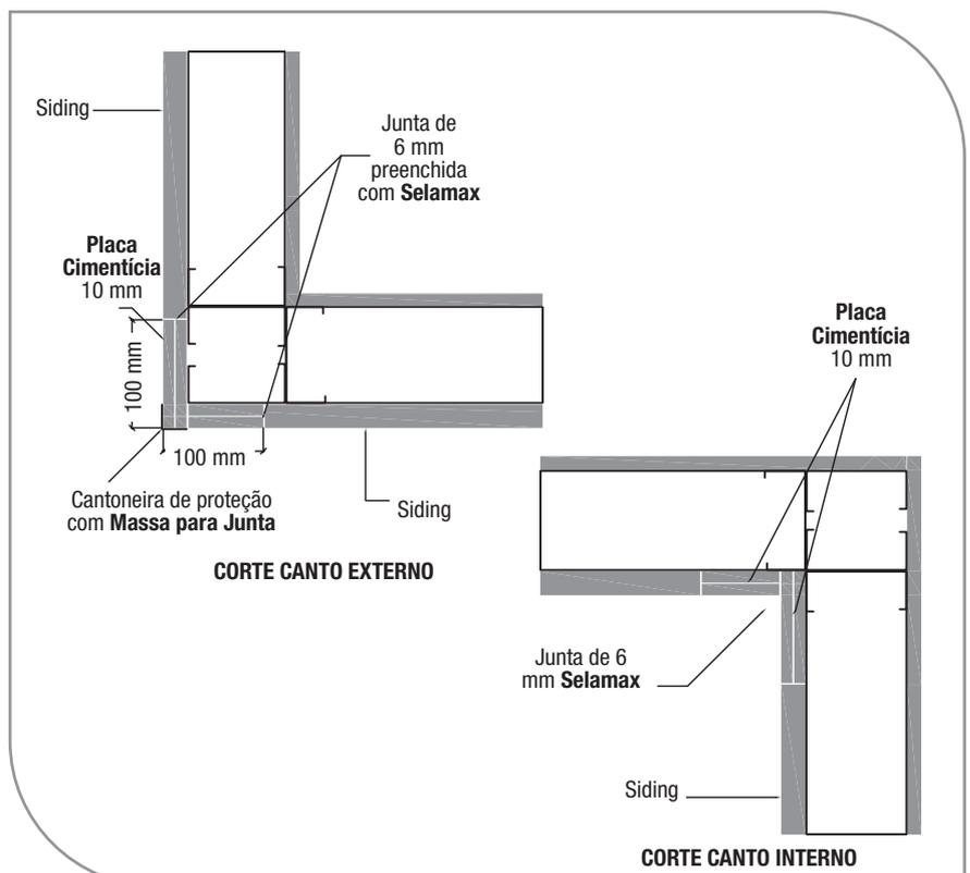
A aplicação ilustrada abaixo não começa pelo arremate dos cantos. O siding é aplicado em toda a extensão das paredes, até os cantos, e o arremate dos cantos internos e externos é aplicado por último. Nesse caso, é preciso aplicar **Massa para Junta** no vão que se forma entre o siding e o arremate para evitar entrada de água.
