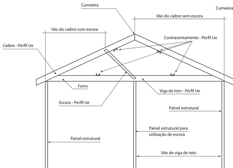
Figura 5.7 - Cobertura estruturada com caibros e vigas
