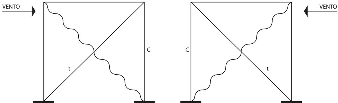
Figura 3.9 - Solicitação das diagonais de contraventamento (a partir de Dias, 1997)
