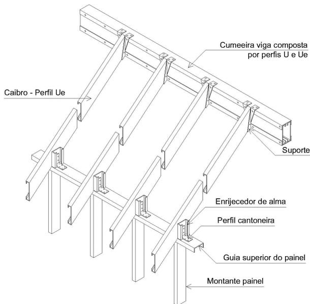
Figura 5.4 - Telhado típico estruturado com caibros
