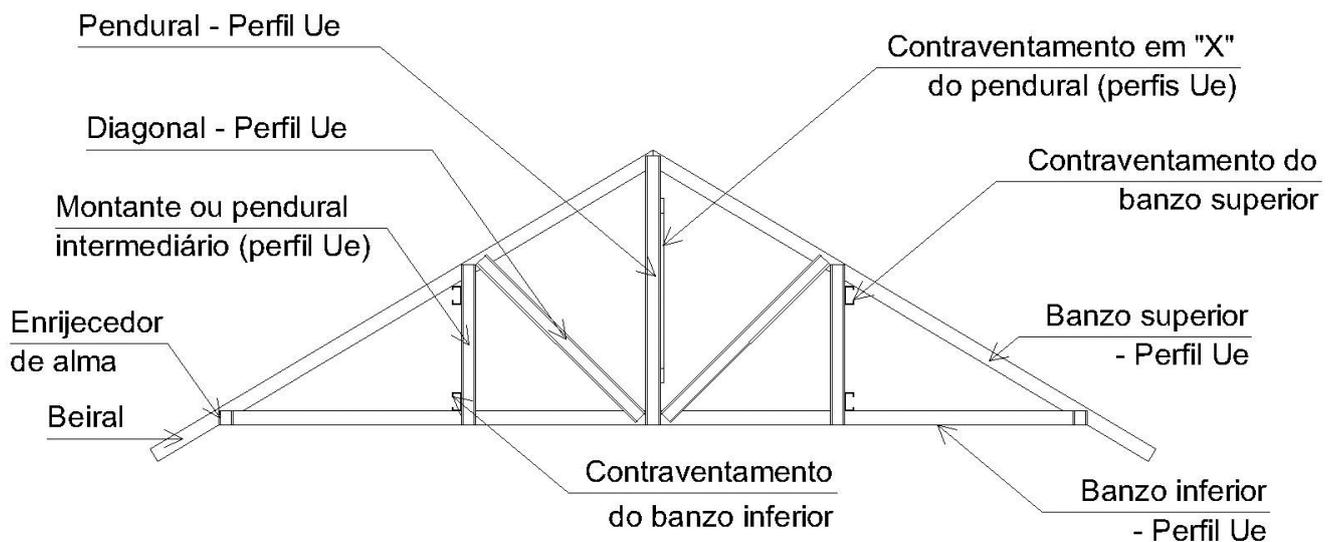
Figura 5.14 - Elementos de uma tesoura
