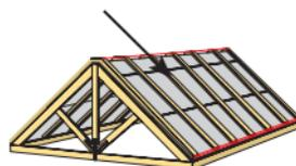
**3** Para a fixação definitiva da manta, aplique ripas (contra-caibros) sobre a manta **SolarMaxxi 4+** pregando-as no mesmo sentido dos caibros. É importante que a manta esteja sempre esticada, evitando a formação de bolsões de água no caso de uma possível infiltração no telhado. Essa etapa é muito importante, pois junto com o ripamento que será instalado logo após, é necessária uma distância mínima obrigatória de 5 cm entre a telha e a manta.
