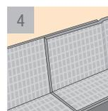
4 Quando houver sobreposição, respeite um espaçamento de 10 cm para evitar a entrada de água.
