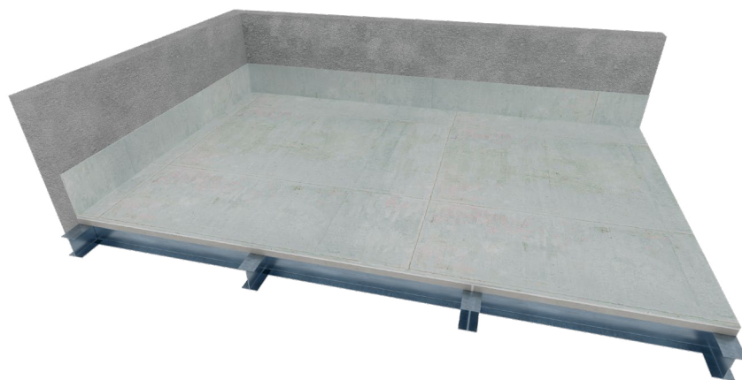
Figura 15: Ilustração do piso com Aquaroc FC® Pisos após aplicação do Acrifast Quartzolit ou Super Manta Líquida Quartzolit.
